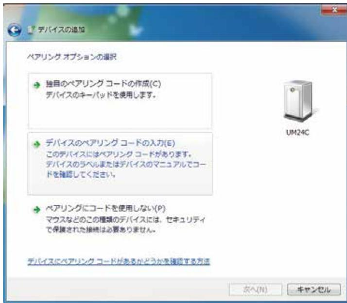
④「デバイスのペアリングコードの入力」を選択し、1234 と入力し、接続をクリックして接続してください。無事に接続しましたら、商品本体の点滅していたインジケーターが点灯に変わります。
