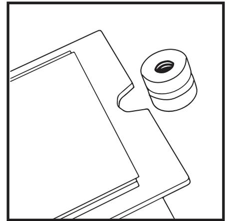
③M.2SSD 先端の窪みにあわせて図のように溝に入るように取り付けます。
