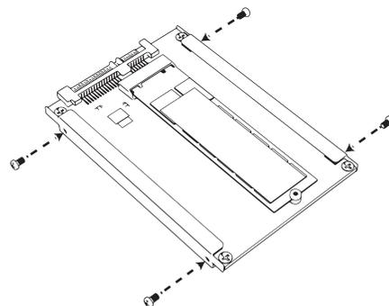
本製品の固定は底面、又は側面からネジ固定が可能です。付属のネジを用いて固定してください。
