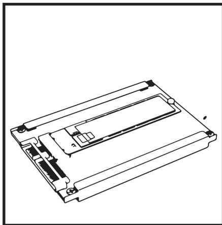
④先に取付けた部品が取れないようにゆっくりと指で SSD を倒してください。
