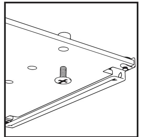
⑥指で SSD を押さえたまま、底面よりネジで固定します。以上で固定の完了です。
