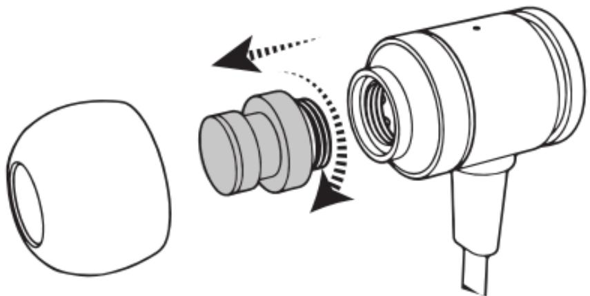
付属の調音ユニットを逆に回して、取り付けます。動かなくなるまで回して取り付けてください。取り付けが甘いと紛失、音漏れの原因になります。
