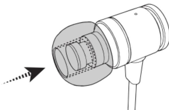
新しいイヤピースを図のようお取り付けください。取り付ける際、必ず筒部分の奥までお取り付けください。
