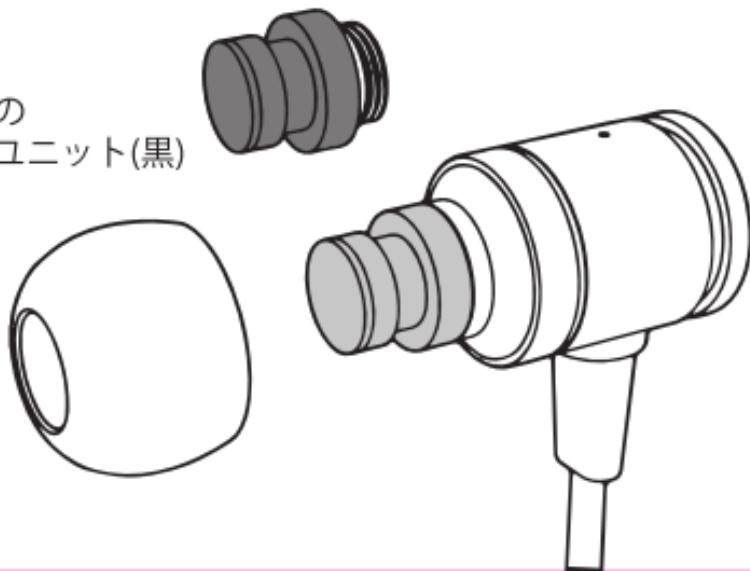
調音ユニットを交換するには、調音ユニットを矢印のように回して、現在ついている調音ユニットを取り外します。
