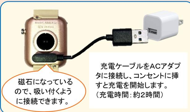
充電ケーブルをACアダプタに接続し、コンセントに挿すと充電を開始します。
