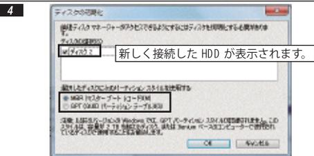
初期化されていない HDD を接続された場合『ディスクの初期化』の画面が表示されますので 3TB 以上の HDD をご利用の場合は GPT を選択して OK をクリックします。2TB までは MBR を選択します。
