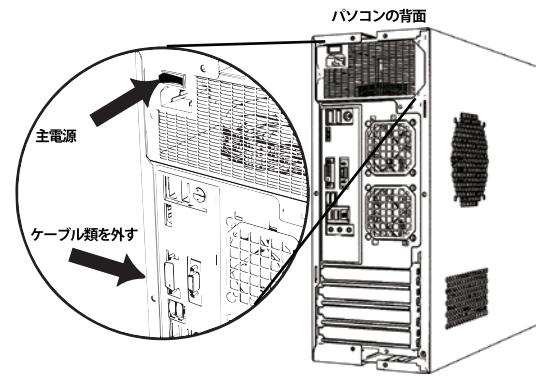
PCがシャットダウンしていることを確認し、背面の主電源を切ってください。また、接続しているケーブル類を全て外してください。
