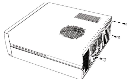
PCケースのカバーを固定しているネジを取り外してください。
