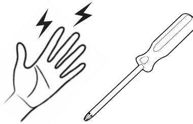
PCは精密機械ですので、増設する前に、身の回りの金属物に手を触れて静電気を逃がしてください。プラスドライバを用意して頂き、平らかつ安定している場所で作業をしてください。
