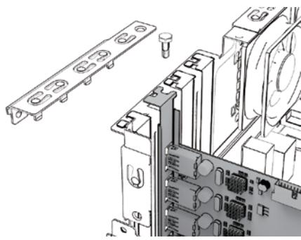
拡張カードをPCケースのネジ穴にあわせて、ネジ固定してください。
