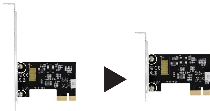
2箇所のネジを取り外して頂き、ロープロファイルブラケットへ交換後取り外したネジで固定してください。
