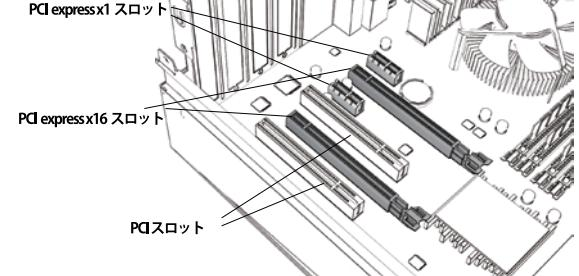
増設する拡張カードが対応しているスロットを確認してください。
