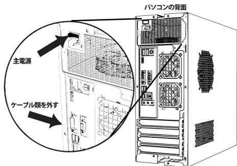
PCがシャットダウンしていることを確認し、背面の主電源を切ってください。また、接続しているケーブル類をすべて外してください。
