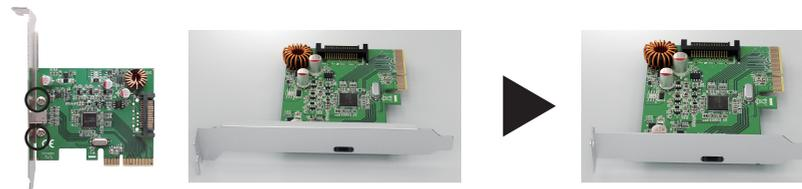
2箇所のネジを取り外して頂き、ロープロファイルブラケットへ交換後取り外したネジで固定をしてください。
