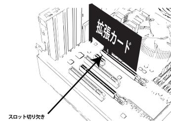
拡張カード(本製品)をスロットの切り欠きを確認し、最後まで垂直にゆっくり挿しこんでください。
