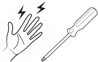
PCは精密機械ですので、増設する前に、身の回りの金属物に手を触れて静電気を逃がしてください。プラスドライバをご用意し、作業ができる平らで、かつ安定している場所にて取り付けてください。
