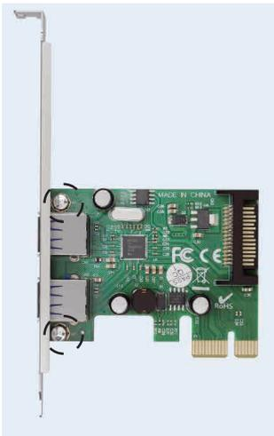
2箇所(箇所)のネジを取り外して頂き、ロープロファイルブラケットへ交換後取り外したネジで固定をしてください。
