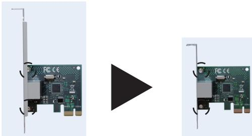
2箇所ネジを取り外して頂き、ロープロファイルブラケットへ交換後取り外したネジで固定をしてください。
