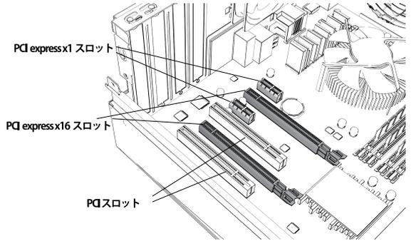
増設する拡張カードが対応しているスロットを確認してください。
