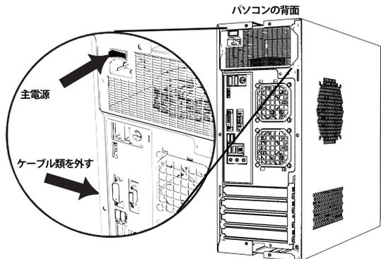
PCがシャットダウンしていることを確認し、背面の主電源を切ってください。また、接続しているケーブル類を全て外してください。
