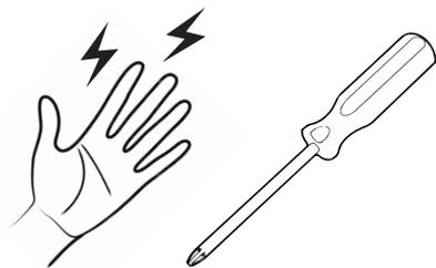
PCは精密機械ですので、増設する前に、身の回りの金属物に手を触れて静電気を逃がしてください。プラスドライバを用意して頂き、平らかつ安定している場所で作業をしてください。
