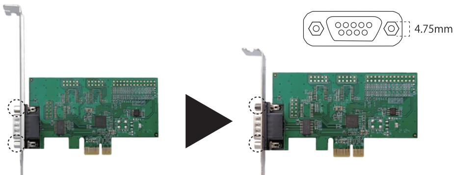
コネクタ横2箇所のネジを取り外して頂き、ロープロファイルブラケットへ交換してください。
