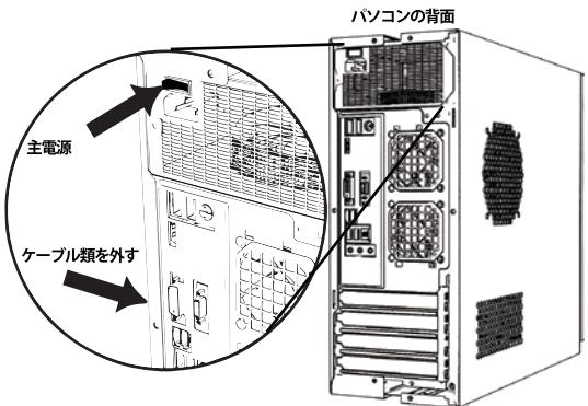
PCは精密機械ですので、増設する前に、身の回りの金属物に手を触れて静電気を逃がしてください。プラズドライバをご用意し、平らかつ安定している場所で作業をしてください。
