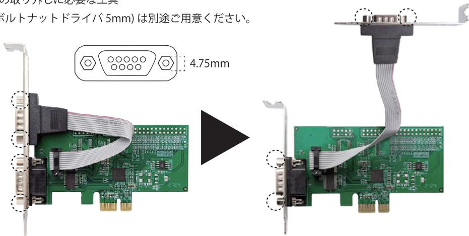
コネクタ横2箇所、のネジを取り外して頂き、ロープロファイルブラケットへ交換してください。
