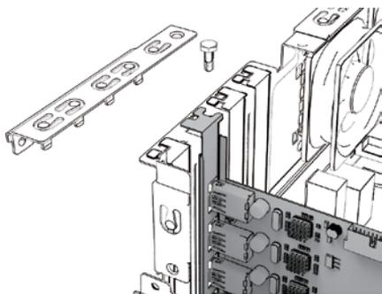
拡張カードを PC ケースのネジ穴にあわせて、ネジで固定してください。
