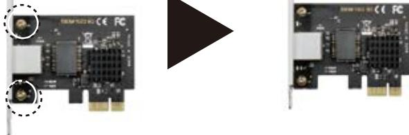
2箇所のネジを取り外して頂き、ロープロファイルブラケットへ交換後取り外したネジで固定をしてください。
