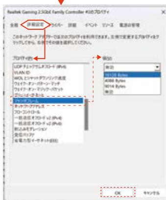
「詳細設定」タブをクリックして頂き、左のプロパティより「ジャンボフレーム」をクリックしてください。
