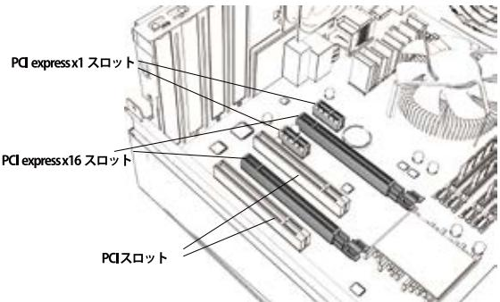
増設する拡張カードが対応しているスロットを確認してください。
