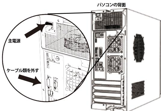
PCは精密機械ですので、増設する前に、身の回りの金属物に手を触れて静電気を逃がしてください。プラスドライバをご用意し、作業ができる平らで、かつ安定している場所にて取り付けてください。
