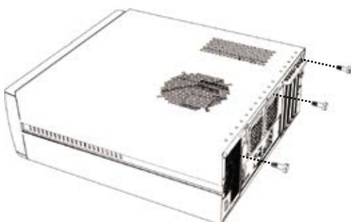
PCケースのカバーを固定しているネジを取り外してください。
