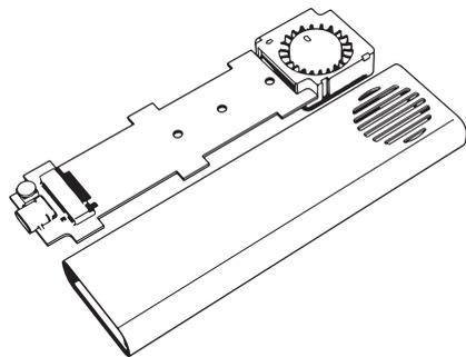
基盤と Fan は L 字の状態で行っ掛けていますので、簡単に取り外せます。
