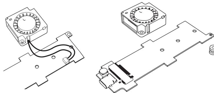
Fan のケーブルは基盤背面に接続されています。
