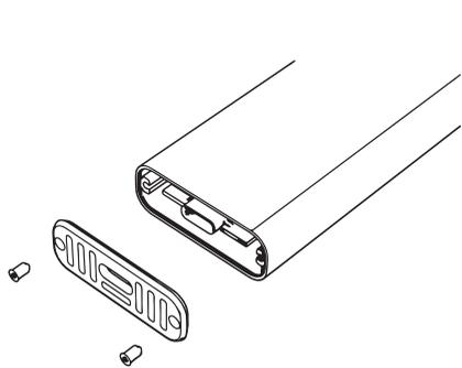
底面のネジを外します。
