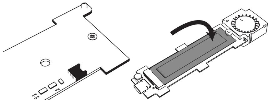
M.2 SSD を押さえて頂き、背面よりネジで固定してください。
